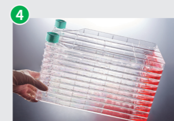
手握住进液口的一面,慢慢地将CellFac® 细胞工厂放倒,变为水平放置,不要抓握第一层的边缘,以防滑落造成损坏
