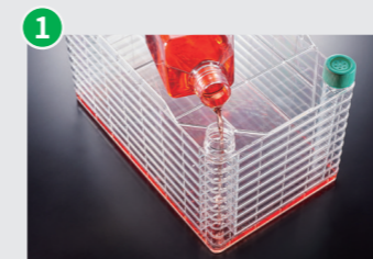
拧开盖子,将培养基直接倒入CellFac® 细胞工厂内
