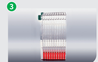
将CellFac® 细胞工厂翻转90度,带有进液口的一面在上,静置一段时间。培养基便会自动平均分配到每一层腔室中
